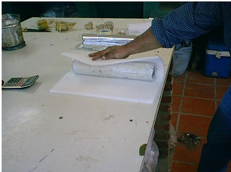
*Fotografía N°24: Parafinado sobre el papel aluminizado y protección con goma pluma de 10,00 mm de espesor.*
