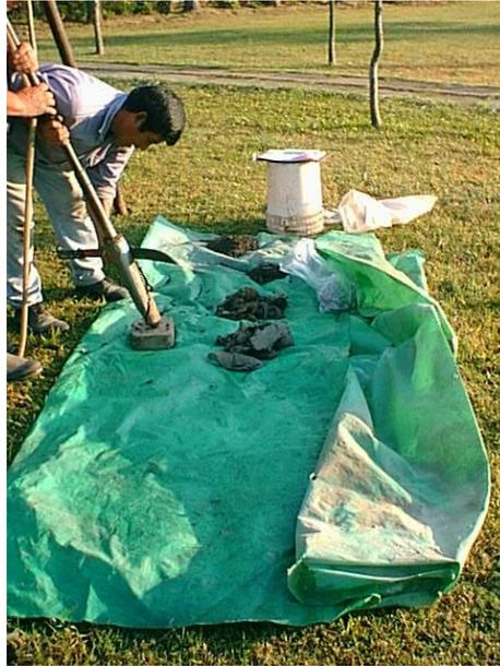
*Fotografía N°16: Extracción de muestras para control de humedad.*
