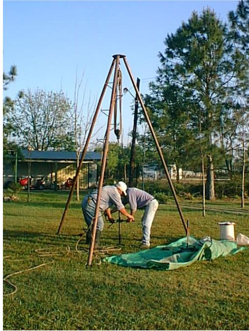
**Fotografía N°3:** Tareas de extracción de muestras para la verificación del perfil estratigráfico.
