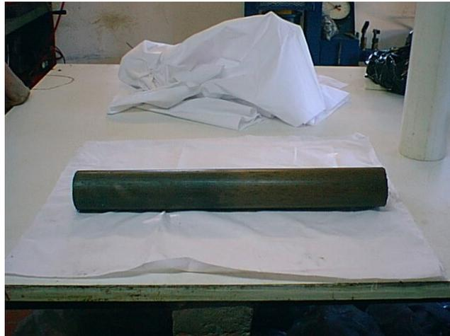
*Fotografía N°21: Muestra desmontada del tubo Shelby.*
