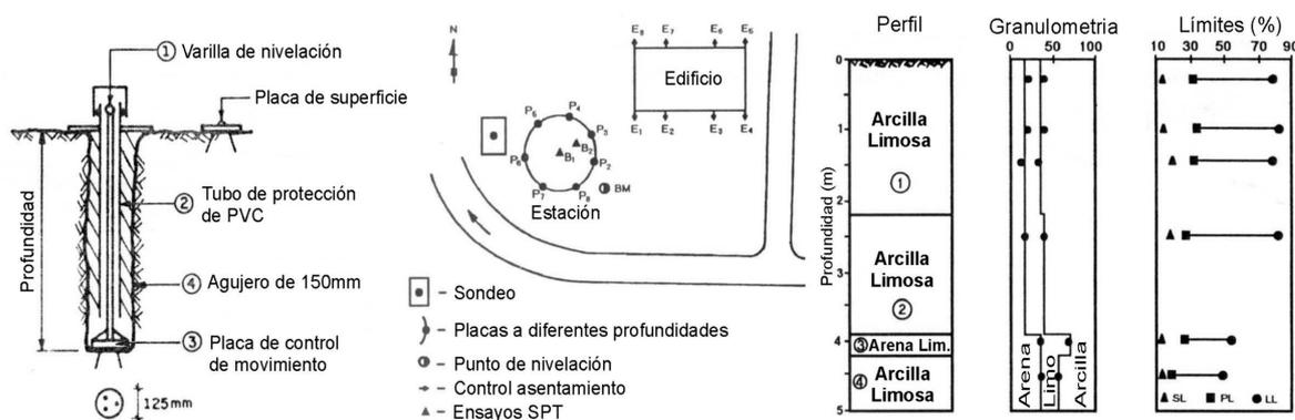
**Figura N°31:** Campo experimental. Instrumentación y perfil de suelo (Gusmao Filho y da Silva, 1991).
